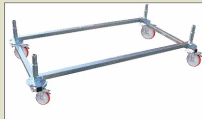
Base RIGIDA scomponibile in 4 elementi con ruote Ø 150mm. nylon fascia rossa EN1004. consente di aumentare la stabilità e la rigidezza del trabattello e permette l'uso di stabilizzatori a vite (optional)
