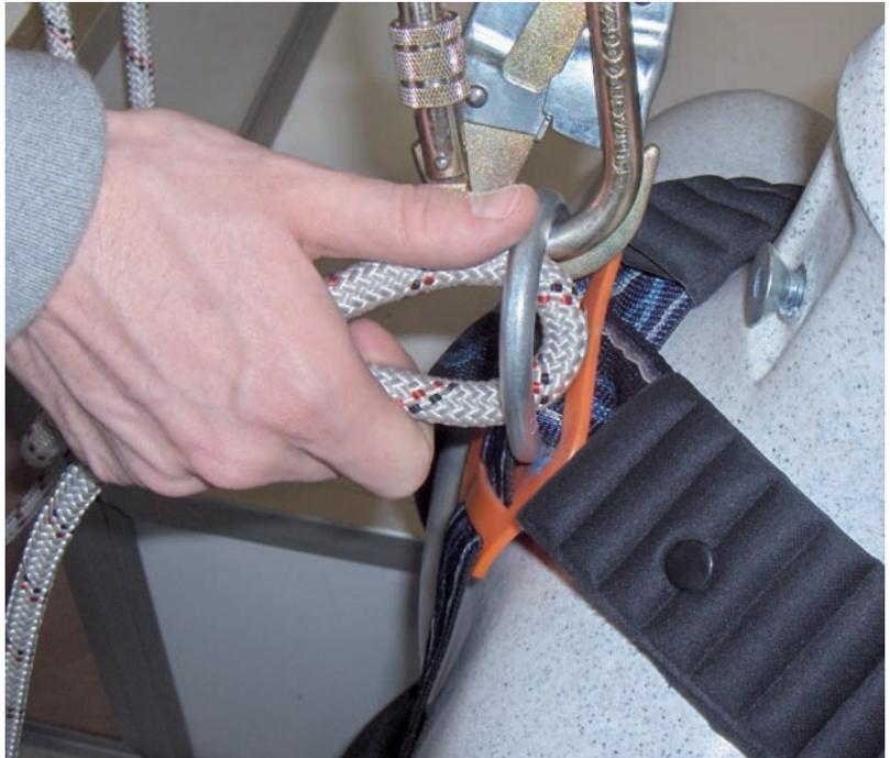
Dettaglio 1 - Formare un'asola con l'estremità scarica del cordino uscente dallo Stopfor K
