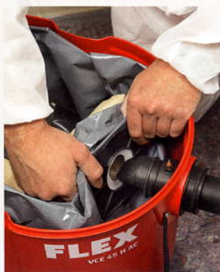
Smaltimento sicuro delle polveri con il sacchetto filtrante di sicurezza a doppia parete.
