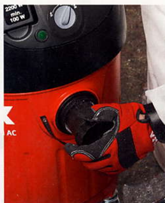
Con l'inserito di chiusura si blocca l'apertura del foro di aspirazione durante il trasporto.
