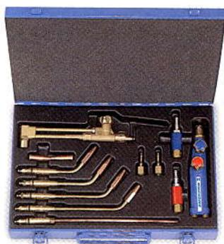
Attrezzamento composto da: impugnatura MINIFROVER, lancia da taglio a rubinetto, punte da taglio 10 e 25 mm, lance saldare 25, 80, 160, 500 lt/h, lancia curvabile 315 lt/h, dispositivi di sicurezza SECURTOP ossigeno e acetilene
