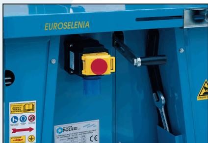
La segatrice è provvista di un interruttore di minima tensione con pulsante rosso di emergenza, e comoda leva di posizionamento dell'altezza lama
